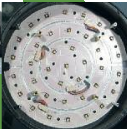
Robe ROBIN 600 LED Wash, valamint a 37 db Cree XLamp MC-E LED chipből álló modul
