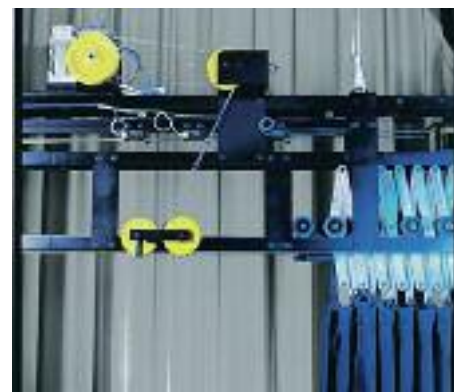
„Fence” ollós rendszerű húzórendszer
