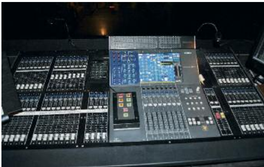
Az M7CL konzol és rajta a QLabhez saját kezűleg készített távvezérlő
