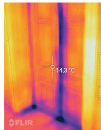
5. kép. Ácsbokos ajtónál tapasztalható légzárási problémák
