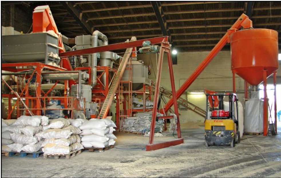
2. kép. Petőházi pelletüzem, balra a kompresszor és az aprítógép, jobbra a kész pellet adagoló tartály helyezkedik el (fotó: Papp V.)
