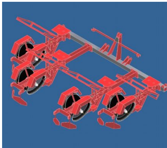
6. ábra. Több ikersorpárú dugványozógép elvi kialakítása
