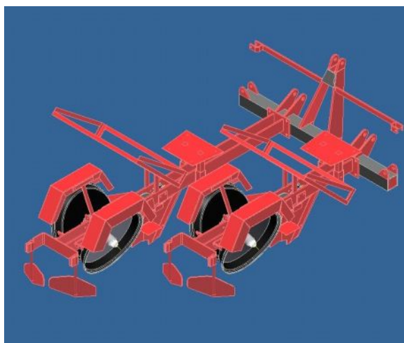
5. ábra. Egy ikersorpárú dugványozógép elvi kialakítása
