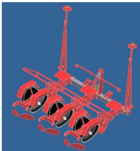
4. ábra. Többsoros dugványozógép elvi kialakítása
