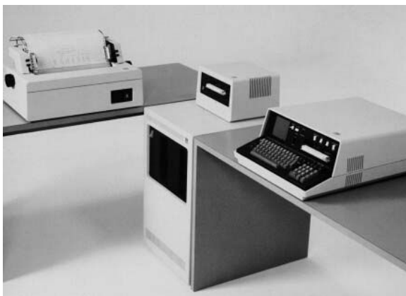
1. ábra: IBM 5110 (alias IBM Yellowstone) teljes konfigurációja: IBM 5103 típusú, 132 karakter széles tűmátrixnyomtató; IBM 5114-es típusú, 2 × 8"-es 1,2 MB-os lemezegység „mosógép” stílusú dobozban; IBM 5106-os szalagos egység; 28 kg-os (hordozható) központi egység
