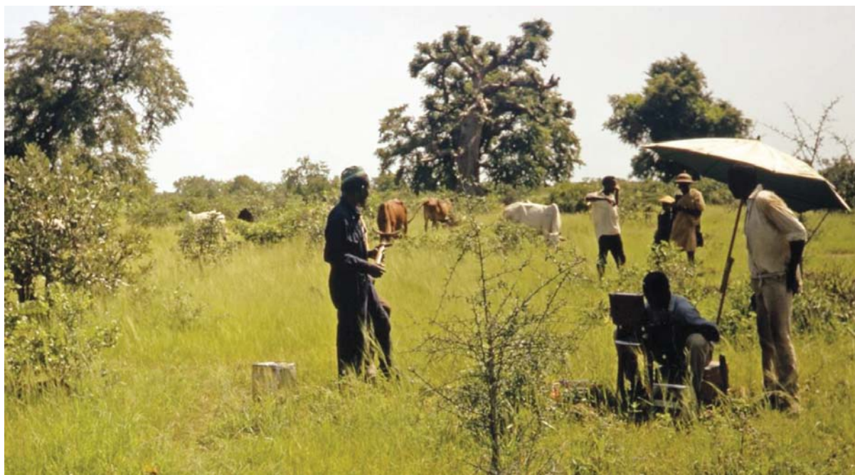
Geoelektromos szondázás az esős évszakban, fuláni pásztorok élénk figyelme közepette
