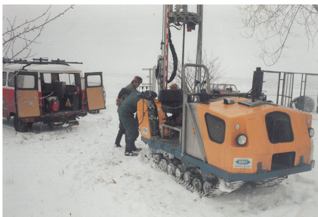
3. ábra. A mérnökgeofizikai szondázó berendezés Sármelléken
