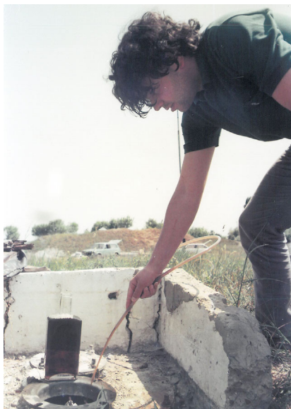
9. ábra. Kalocsai repülőtér: így jött a földből a „Silov-koktél” (kerozin 95%, talajvíz 5%)
