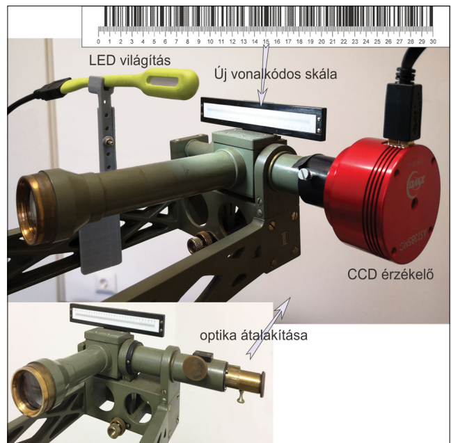
14. ábra | Az inga leolvasóberendezésének automatizálása Figure 14 | Reading the scale of the torsion balance has been automated
