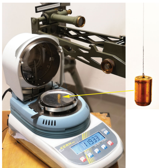
20. ábra | A felfüggesztett tömeg mérése Kern DLB precíziós labor-mérleggel
