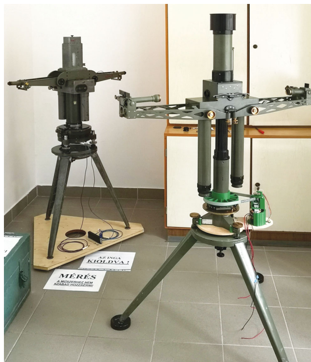
12. ábra A mérésekre kész műszerek a BME Általános- és Felsőgeodézia Tanszékén. Balra hátul az Auterbal-, jobbra elől az Eötvös–Pekár-inga
