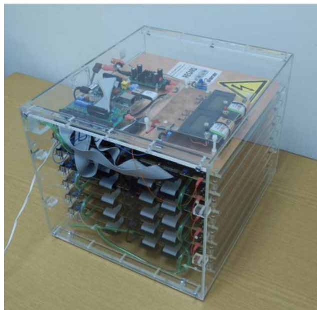
15. ábra A hat közeli katódos kamrából (CCC) felépülő hordozható müondetektor fényképe [41]
