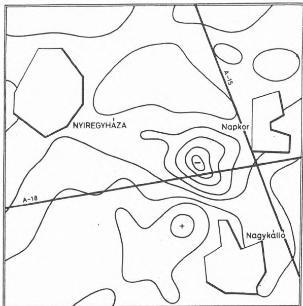
5. ábra. Szeizmikus és magnetotellurikus vonalak a földmágneses térképen. (A mágneses hatószámítások az A-18 nyomvonalán a napkori anomáliára történtek)
