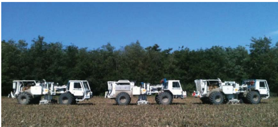
6. ábra | 25 tonnás HEMI 50 típusú vibrátorok működés közben Figure 6 | HEMI 50 type vibrators of weight 25 tons on the site
