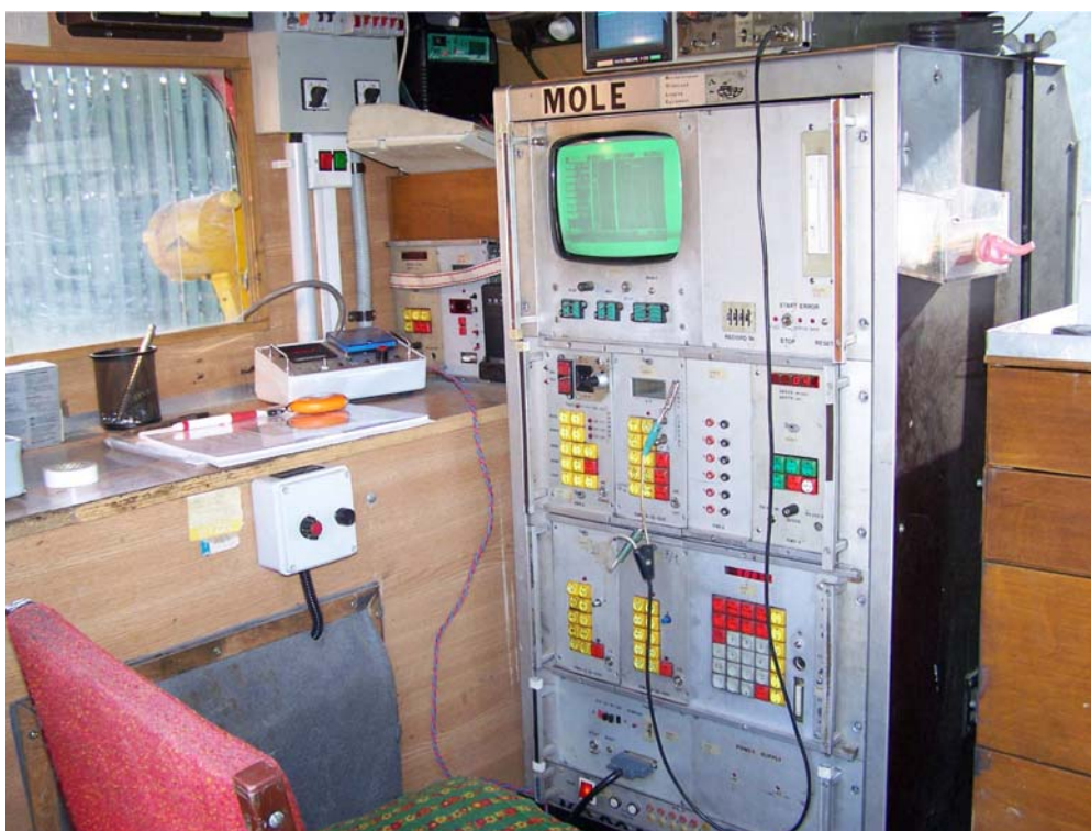
7. ábra. A MOLE műszerkocsiba építve napjainkban (A floppy helyett pendrive-ra történik az adatrögzítés)
