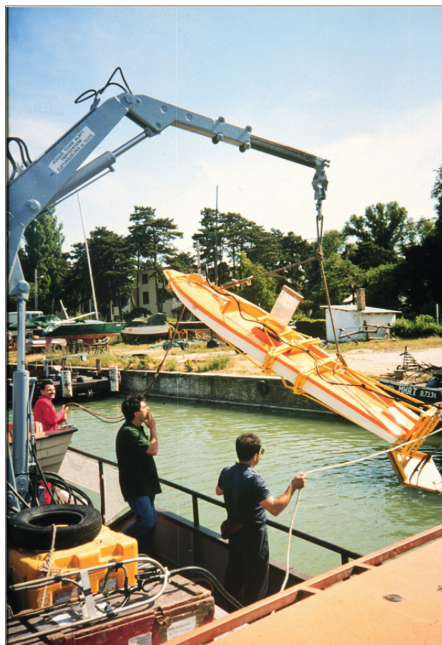
1. ábra A boomer forrás és a hozzá tartozó hordozó test vízre emelése a siófoki kikötőben, 1993 nyarán (Sacchi, 2001)
