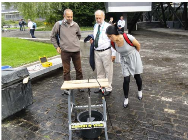
Prónay Zsolt és Ormos Tamás egy mérnök-szeizmikus hullámforrást figyelnek a terepi bemutatón
