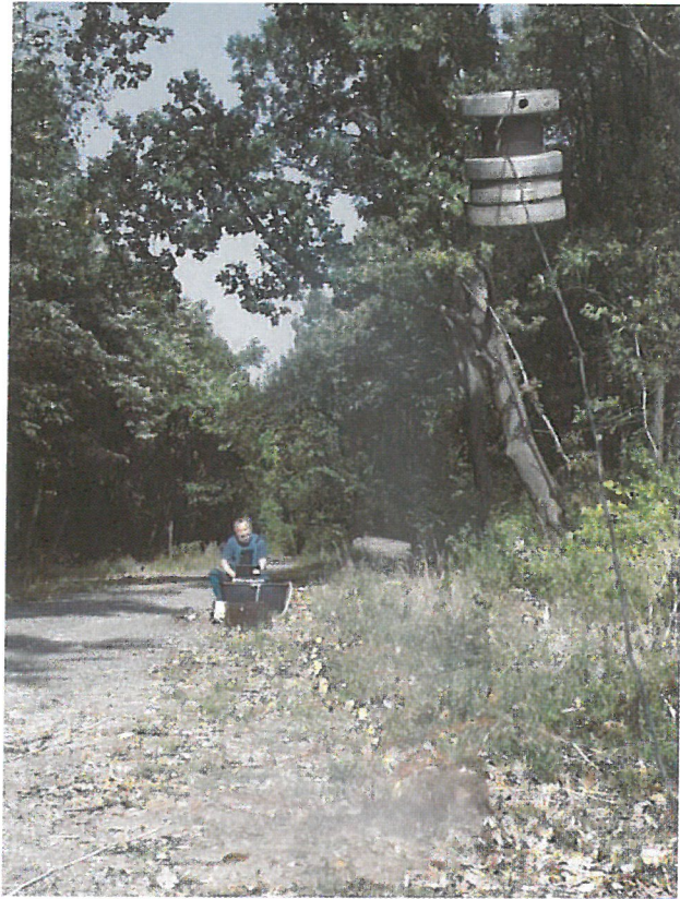
3. ábra. A kenguru, SRII szeizmikus rezgékeltető Fig. 3. The kangaroo, SRII seismic source
