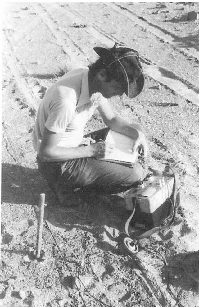
LUKÁCS József gerjesztett polarizáció mérése közben a Suten nevű mérési területen. A Geofizikai Intézetben készült Diapir-E típusú műszer a mostoha körülmények között is jól vizsgázott
