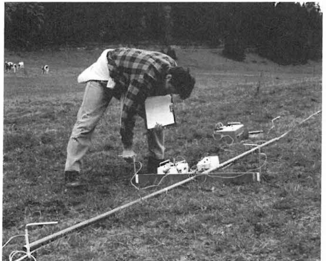
7. ábra. Terepi mérés geoelektromos null-elrendezéssel (Schlumberger-elrendezés). A műanyag cső és a lécvégpontjai szolgálja a geometriai pontosságának növelését szolgálja. A cső két végén az áramelektrodák, míg a lécvégpontjainál a potenciál-elektrodák találhatók
