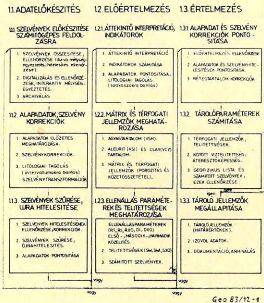
1. ábra. Mélyfúrású geofizikai (karotázs) szelvények feldolgozásának folyamatai, számításai (Tárolóparaméterek meghatározása)
