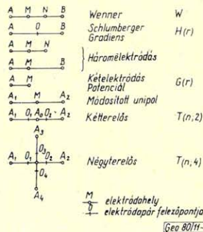
1. ábra. Különböző elektróda-elrendezések
