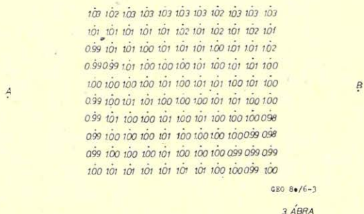
3. ábra. A mért és számított potenciálkülönbségek hányadosai kétréteges féltér felszínén
