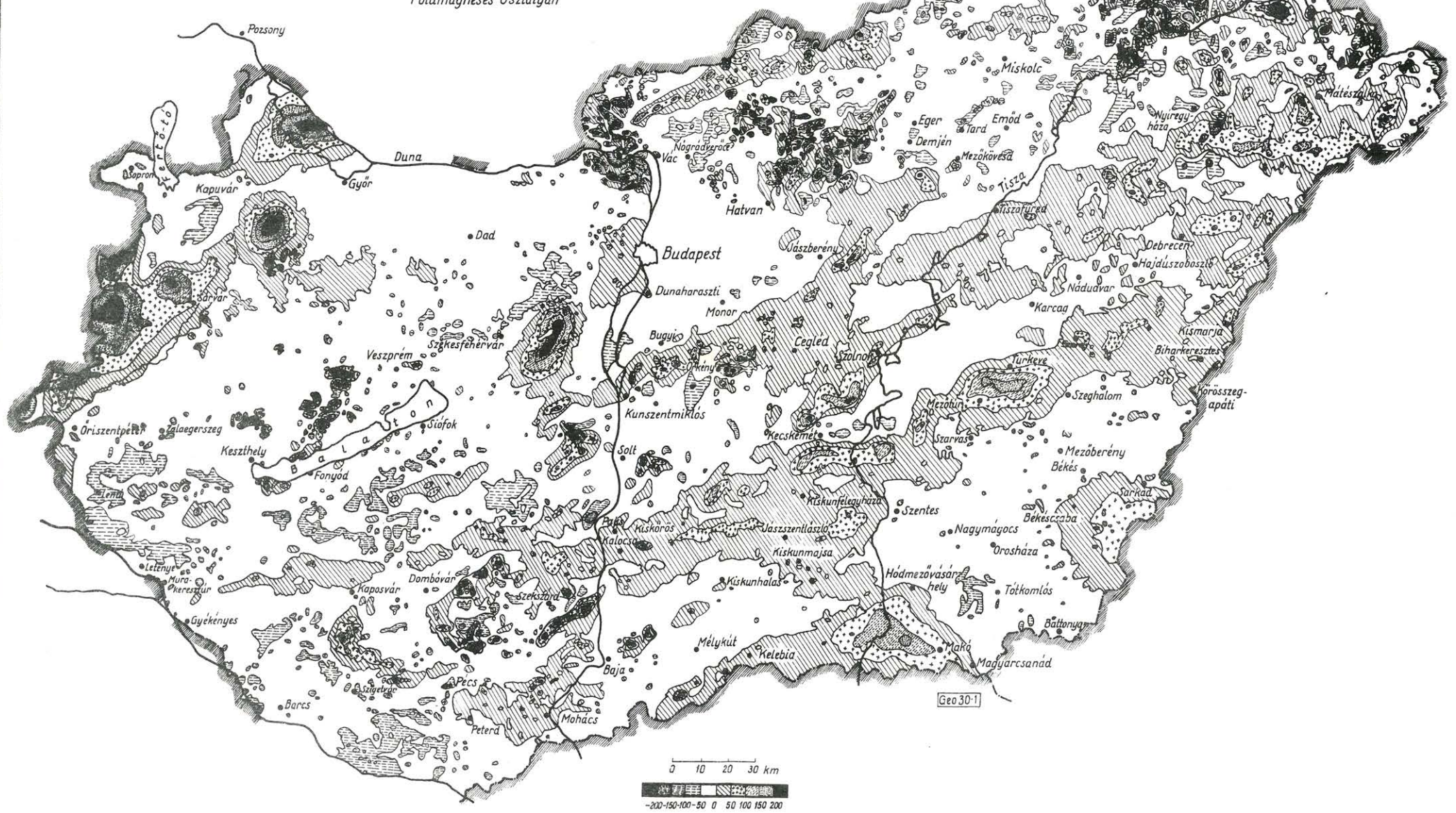
A földmágnesség függőleges térerősségének izanomál vonalai Magyarországon az 1951 május 23-tól 1961 augusztus 14-ig végzett áttekintő felvétel eredményei szerint Készült dr. Haáz István irányításával a M. Áll. Eötvös Loránd Geofizikai Intézet Földmágnesses Osztályán
