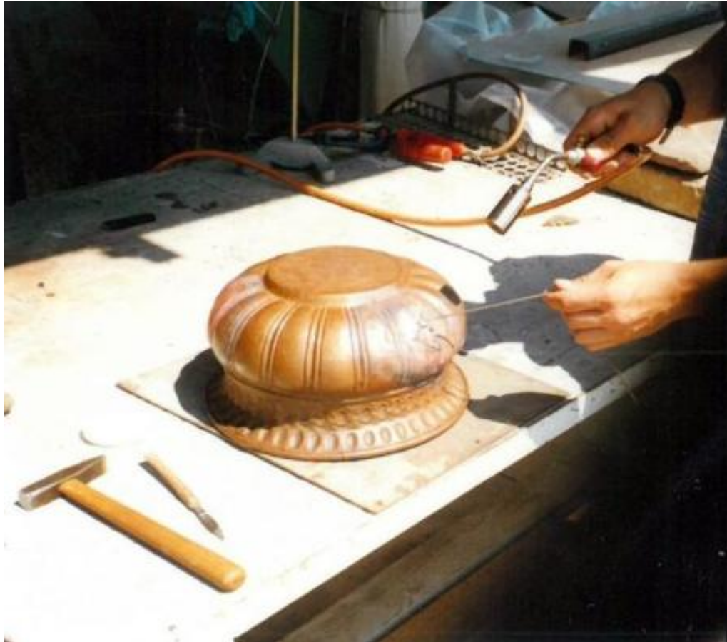
4. ábra: A hiányzó rész pótlása forrasztással
