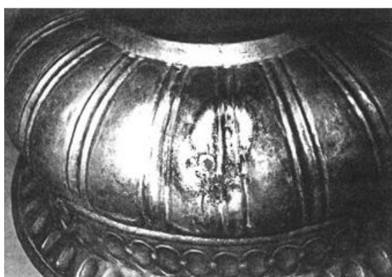
3. ábra: Régebbi forrasztás nyomai
