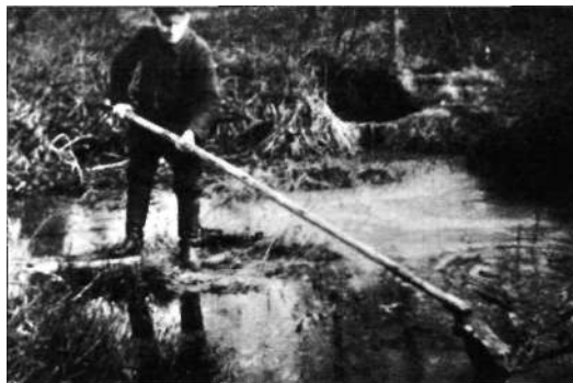
Kőolaj összegyűjtése víz felszínéről lófarokkal
