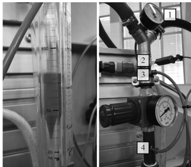
2. ábra. Rotaméter (balra), valamint a reduktor, az analóg nyomásmérő (1), a K-típusú hőelem rendszerbe vezetése (2), megcsapolás nyomásméréshez a reduktor után (3), illetve előtt (4)
