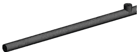
4. ábra Az alkalmazott numerikus háló
