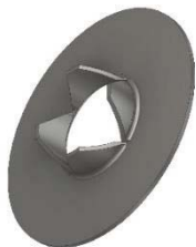
2. ábra: Bevágással készített borda ábrája
