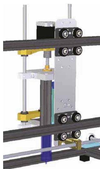
17. ábra - A festékadagoló fej rögzítése
