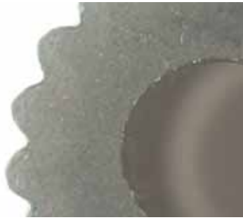
15. ábra. A z=19 , m=0,3 mm SLA nyomtatással létrehozott fogaskerék legalsó rétegének 25x nagyítású mikroszkópos képe
