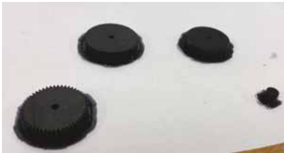
22. ábra. A fogaskerék a támaszokkal ellátva, közvetlenül a nyomtatás után
