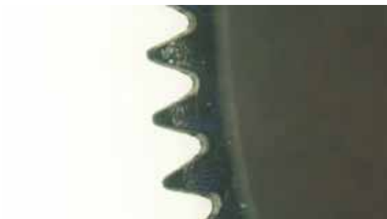
29. ábra. A z=94 , m=0,3 mm SLA nyomtatással létrehozott agyas fogaskerék legalsó rétegének 25x nagyítású mikroszkópos képe
