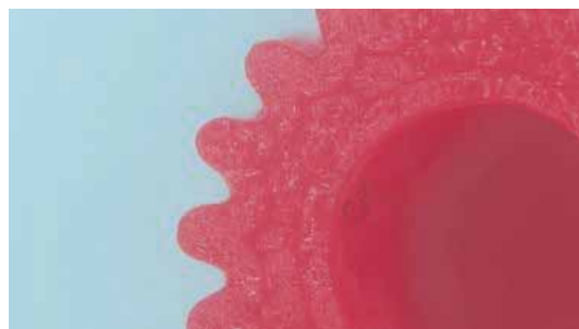
7. ábra. A z=19 , m=0,3 mm FDM nyomtatással létrehozott fogaskerék legfelső rétegének 25x nagyítású mikroszkópos képe
