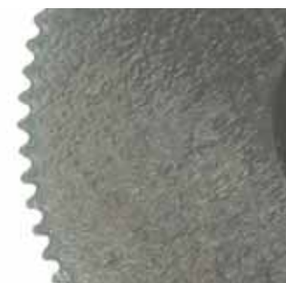
14. ábra. A z=90 , m=0,1 mm SLA nyomtatással létrehozott fogaskerék legfelső rétegének 25x nagyítású mikroszkópos képe
