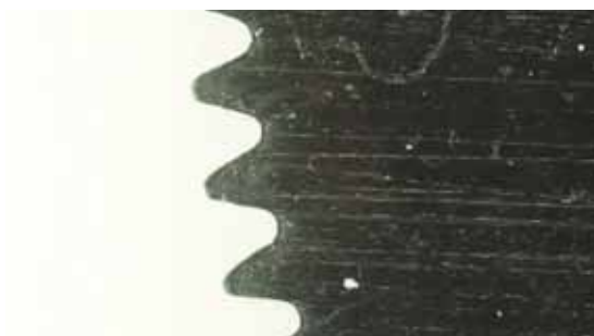
30. ábra. A z=94 , m=0,3 mm SLA nyomtatással létrehozott agyas fogaskerék legfelső rétegének 25x nagyítású mikroszkópos képe
