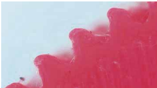
10. ábra. A z=50 , m=0,5 mm FDM nyomtatással létrehozott fogaskerék legalsó rétegének 25x nagyítású mikroszkópos képe
