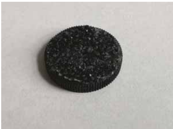
23. ábra. A támaszok eltávolítása után kapott fogaskerék
