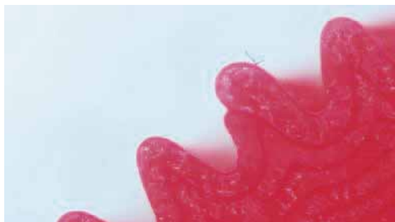
11. ábra. A z=50 , m=0,5 mm FDM nyomtatással létrehozott fogaskerék legfelső rétegének 25x nagyítású mikroszkópos képe
