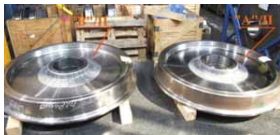
7. ábra A vizsgálatra előkészített kerékpár bevonattal és hálózattal
