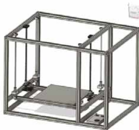
11. ábra: A vázszerkezet, tárgyasztallal és a z-tengellyel
