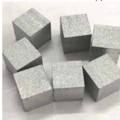
4. ábra. A TE-modulok Bi 2 Te 3 pelletjei [6]
