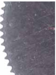
26. ábra. A z=90 , m=0,1 mm SLA nyomtatással létrehozott agyas fogaskerék legfelső rétegének 25x nagyítású mikroszkópos képe
