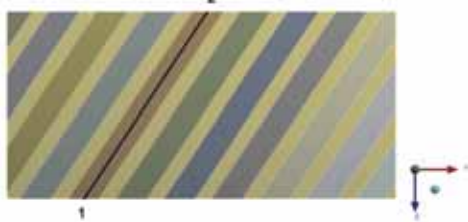
15. ábra. Az egyik szálköteg közepén értelmezett nyomvonal
