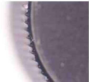
25. ábra. A z=90 , m=0,1 mm SLA nyomtatással létrehozott agyas fogaskerék legalsó rétegének 25x nagyítású mikroszkópos képe
