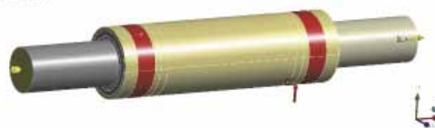
4. ábra. A kompozit tömlődarab terhelései és peremfeltételei a végeeselemes makromodellben
