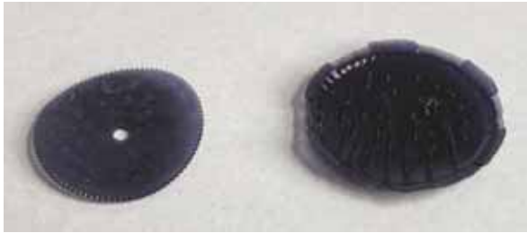
21. ábra. A támaszokról leválása után készült „fogaskerék” (balra) és a támaszok (jobbra)
