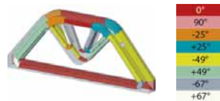
6. ábra: Szegmentált szálirányok és a többsítített erősítőrétegek
