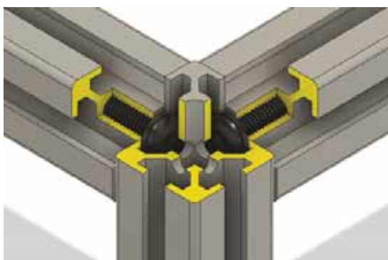
9. ábra: Alumíniumprofilok egymáshoz rögzítése D-fejű csavarral
