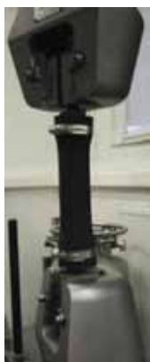
2. ábra. A kompozit tömlőszakasz egytengelyű húzóvizsgálatának kísérleti elrendezése
