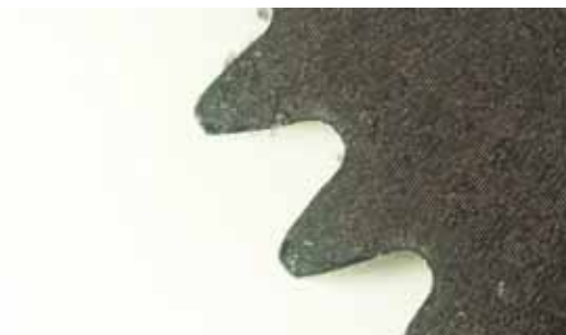
32. ábra. A z=50 , m=0,5 mm SLA nyomtatással létrehozott agyas fogaskerék legfelső rétegének 25x nagyítású mikroszkópos képe
