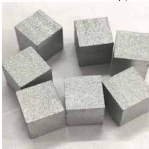
4. ábra. A TE-modulok Bi 2 Te 3 pelletjei [6]
