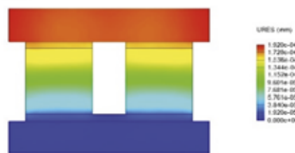
9. b. ábra. A terhelés hatására kialakuló elmozdulások egységnyi elemkonstrukcióban
