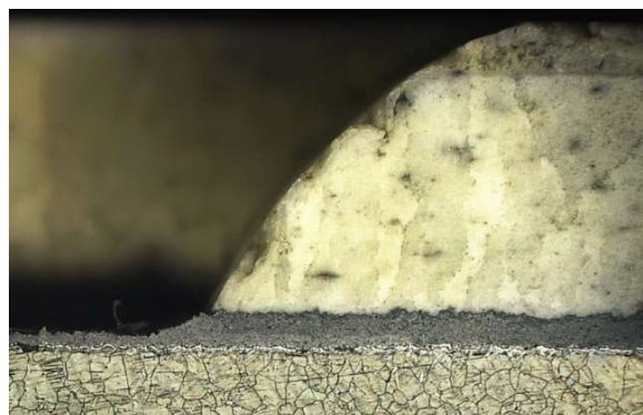
4. ábra. Az AQ Anton által épített gép lézeres kerámia megmunkálása után készített metszet nem mutat leváláshoz vezető repedést
