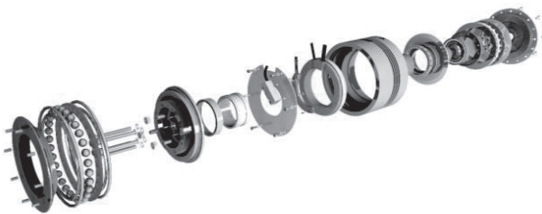
3. ábra: A kísérleti síkkerekes hullámhajtómű robbantott ábrája
