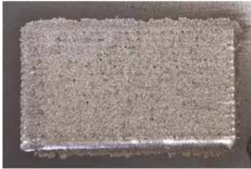
18. ábra. A lézerrel bevonatolt felület 2 mm-es sáv eltolással
