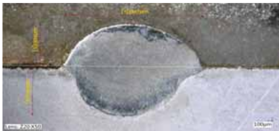
15. ábra. A 11 mm-es defókusszal készült bevonat jellemző keresztmetszeti képe magasabb portömegáramnál
