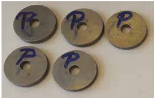
19. ábra. Lézerrel bevonatolt, a koptatáshoz kimunkált minták
