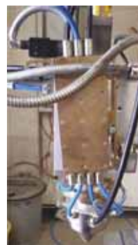
4. ábra. A porszóráshoz használt lézeres megmunkálófej fotója
