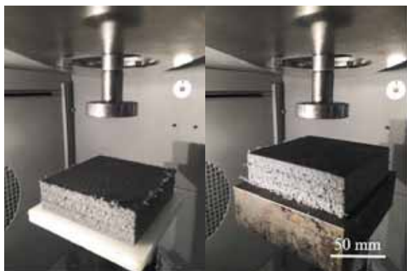
2. ábra. Módosított mérési konstrukciók: PA és acél alátámasztás
