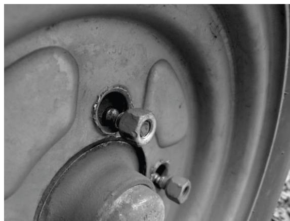
3. ábra. Utánfutó kerék kilazult csavarokkal [1]
