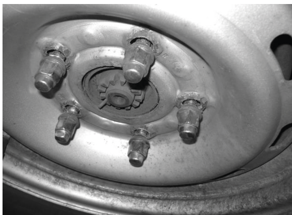
4. ábra. Kisteherautó kerék kilazult csavarokkal [2]
