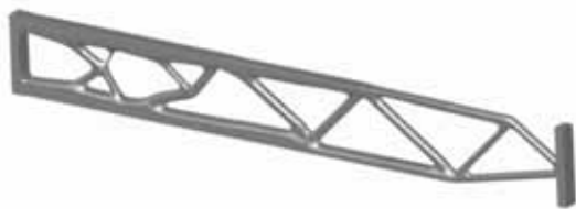
6. ábra. Generatív design után kapott geometria
