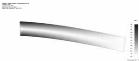
2. ábra. Feszültségeloszlás hajlított tartón
