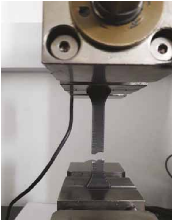
4. ábra A próbatetest szakadása
