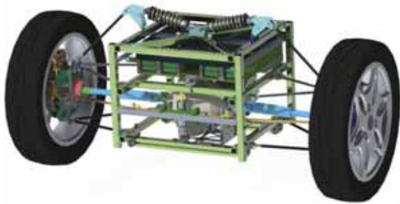
1. ábra - A BME Fuse egyetemi versenycsapat járművének integrált meghajtó modulja
