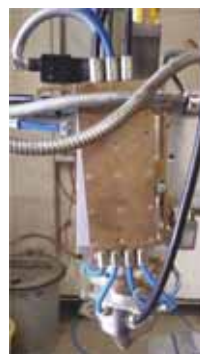
4. ábra. A porszóráshoz használt lézeres megmunkálófej fotója
