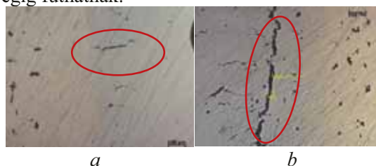
4. ábra. A CL92(a) és CL80 (b) alapanyag határfelületi repedései
