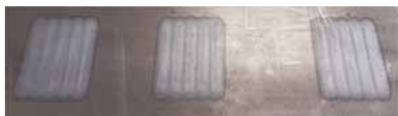
11. ábra. A sávosan edzett felületek a koptató próbatestek kimunkálásához
