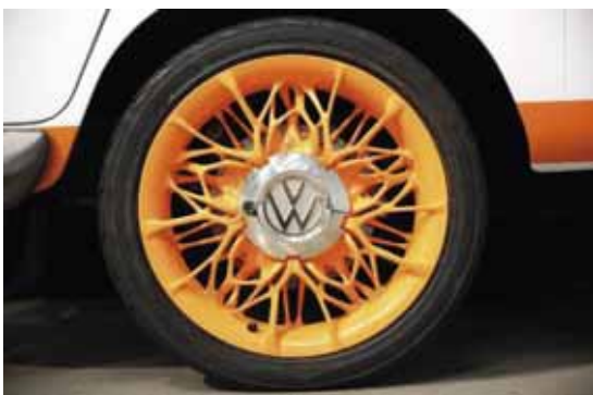
2. ábra - Generatív tervezéssel meghatározott kialakítású felni [2]
