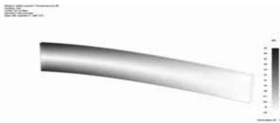
2. ábra. Feszültségeloszlás hajlított tartón
