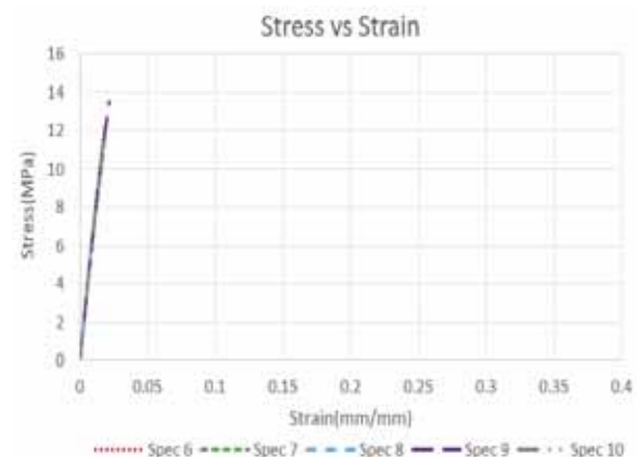
6. ábra: A nyomtatott öt próbatetest feszültség-alakváltozás diagramja 90° esetén
