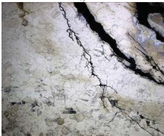
7. ábra Jellemző repedések maratás után, 2-es mintavételezési hely különböző részein (Királyvíz, N = 200x )[10]
