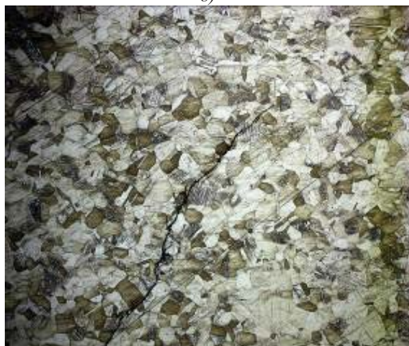
6. ábra Jellemző repedések maratás után, 1-es mintavételezési hely különböző részein (Királyvíz, N = 200x) [10]
