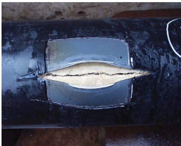
3. ábra Polimer mátrixú kompozittal, belülről megerősített, mesterséges hibát tartalmazó csőszakasz, repesztővizsgálat után
