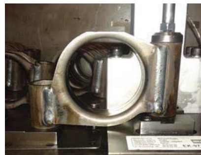
3. ábra. A vizsgálandó alkatrész az ellenőrzést szolgáló idomszerben
