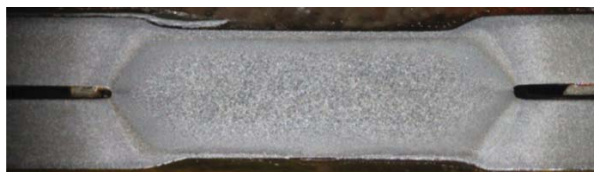
4. ábra. DP acél folyamatos és szakaszos energiabevittel készült ellenállás-ponthegesztett kötésének heglencséje [16]
