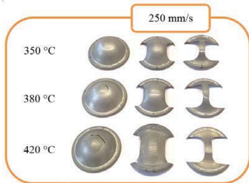
7. ábra. Különböző hőmérsékleteken ( T=350^{\circ}\text{C} , 380^{\circ}\text{C} , 420^{\circ}\text{C} ), állandó sebességgel ( v=250\text{ mm/s} ) alakított próbatest sorozat
