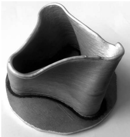
9. ábra Egysoros varratokból felépített alakos test
