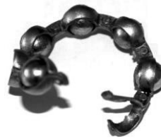
5. ábra. A kosárszerkezet károsodása
