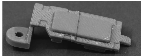
5. ábra. Próbanyomatás FDM technológiával
