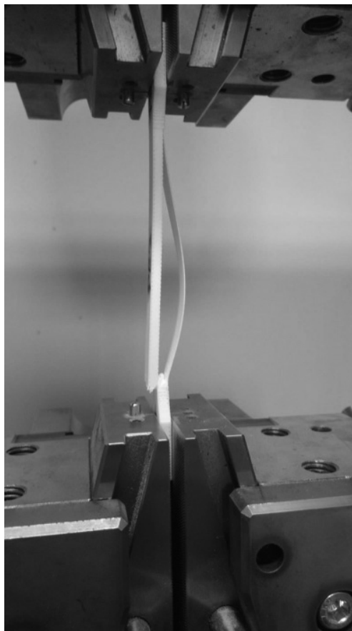
5. ábra. Az XZ orientációval nyomtatott PET-G alapanyagú próbatest szakítás utáni állapota
