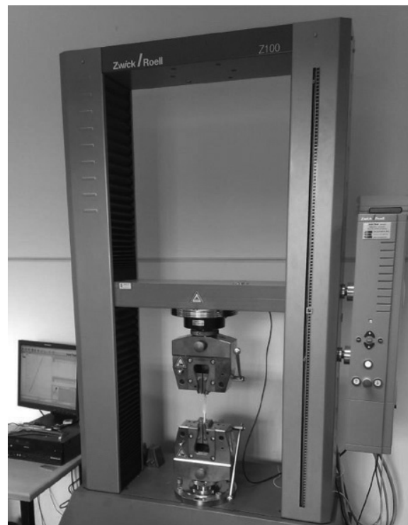
3. ábra. A vizsgálat során használt Zwick/Roell Z100 típusú szakító gép
